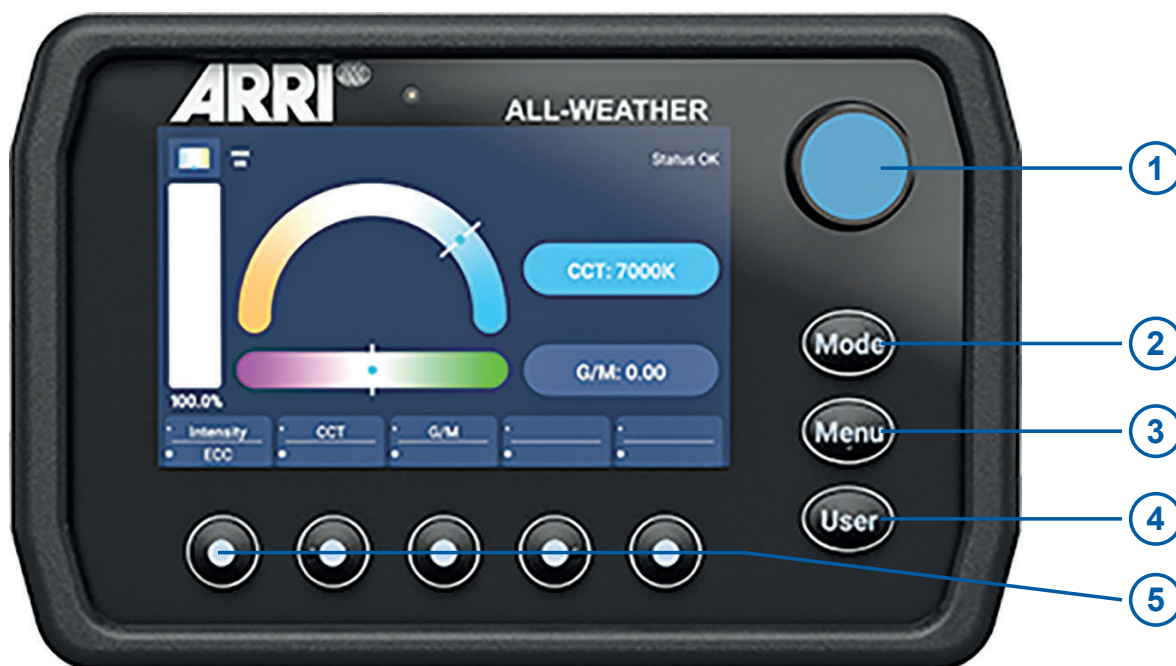
Illustration 17: Kontrollpanelens manöverelement
